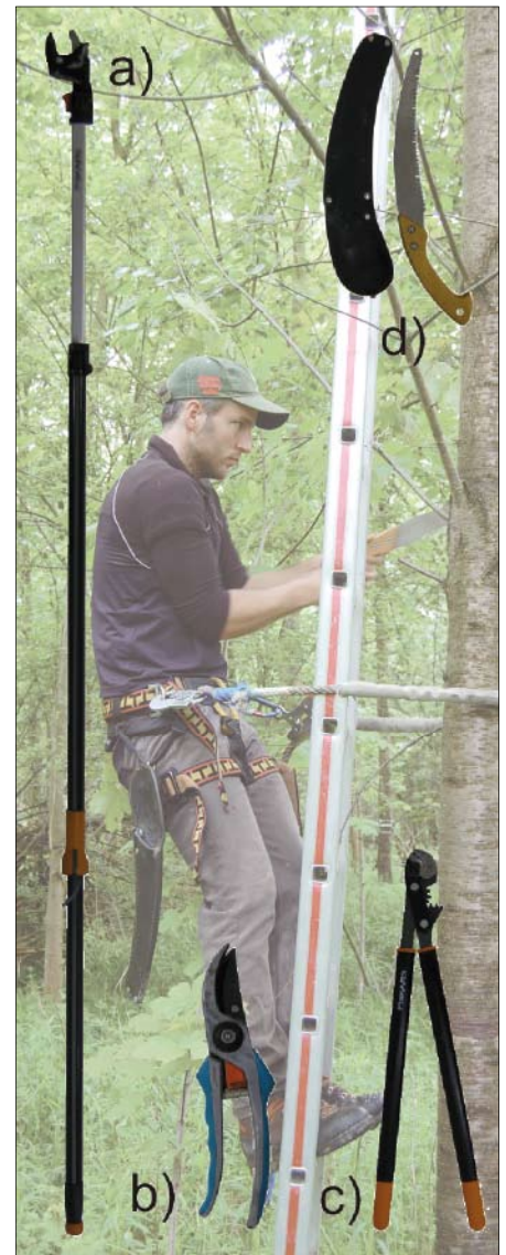
Abb. 1: Astungswerkzeug: a) Schneidgiraffe mit Teleskopstiel, b) kleine Astschere, c) große Astschere, d) Astungssäge Foto: C. Morhart
